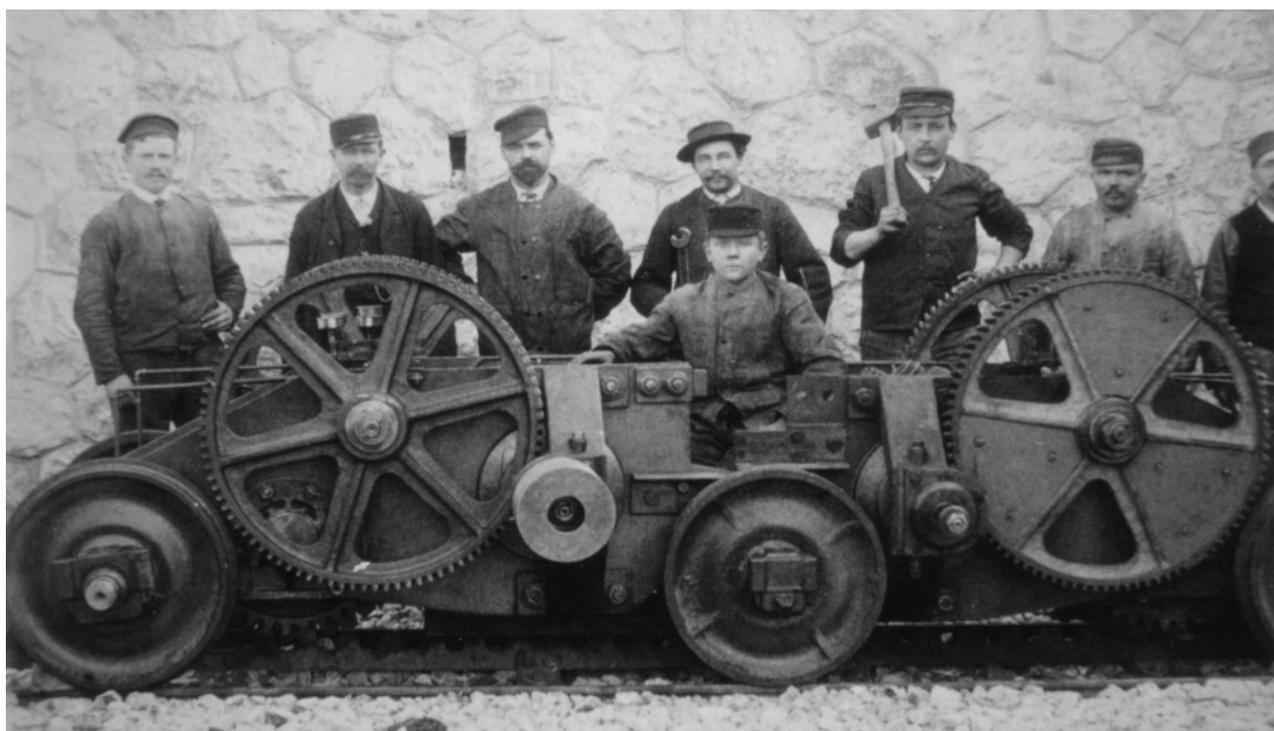
Illust. 09 – Châssis d'une voiture automotrice au dépôt d'Étrembières. La vitesse permise sur la pente la plus forte est de 6 km/h ou 100 mètres/minute, correspondant à 50 tours/minute aux pignons, leur cercle primitif ayant une circonférence de 2 mètres et le rapport de réduction des engrenages étant de 1:12.
