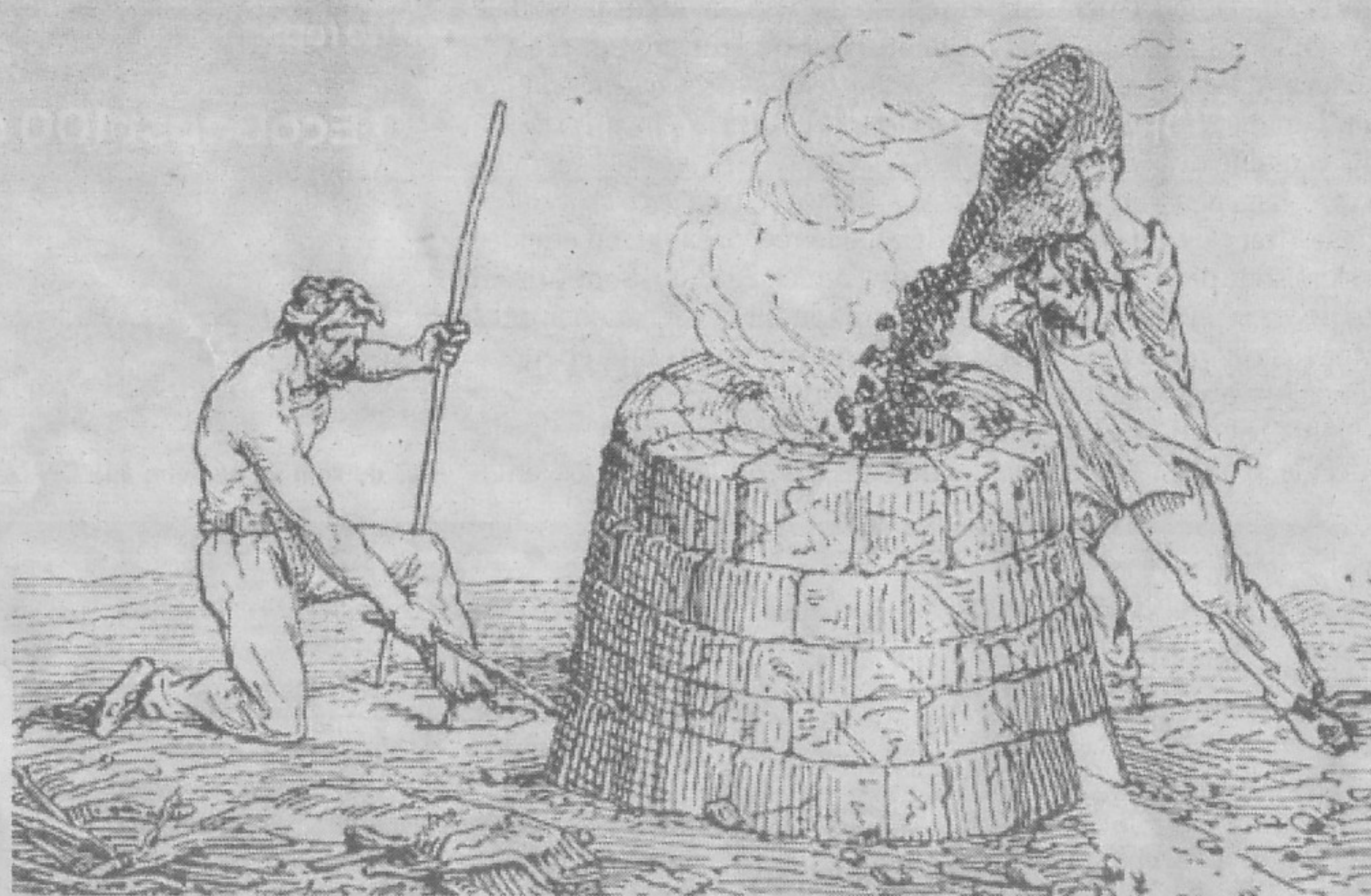
Le fonctionnement d'un bas fourneau était assez simple, mais ceux construits par les Burgondes sur le Salève étaient sans doute plus sommaires et plus petits.
